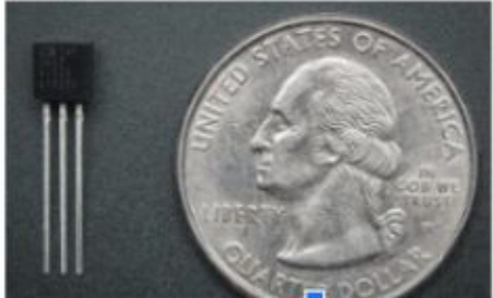
Arduino Mini Pro TMP36 Temperature Sensor
